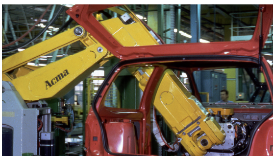
Dans les usines, les robots sont capables d'effectuer des tâches répétitives comme les soudures (photo du haut) ou la peinture sur les chaînes de montage des automobiles. (© Renault).
