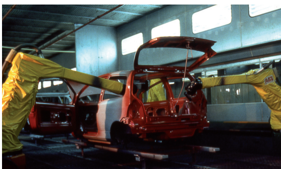
Dans les usines, les robots sont capables d'effectuer des tâches répétitives comme les soudures (photo du haut) ou la peinture sur les chaînes de montage des automobiles. (© Renault).
