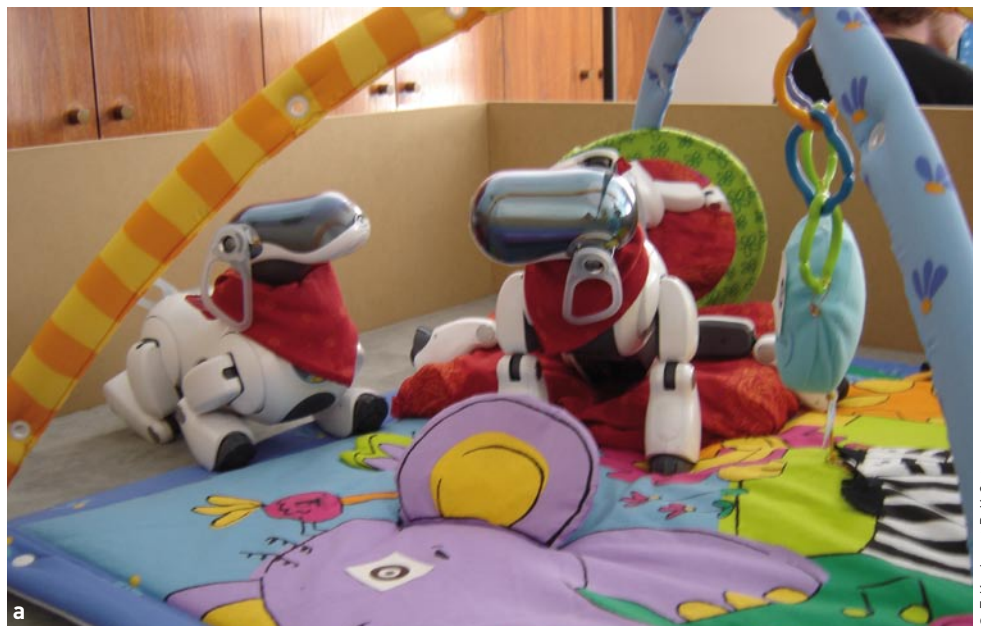
Le robot AIBO, développé par Sony, est utilisé par les chercheurs pour étudier comment un système de curiosité peut lui permettre de découvrir seul son environnement (a) et quels sont les mécanismes qui permettent d'apprendre les mots correspondants aux objets expérimentés en interagissant avec un humain (b).
